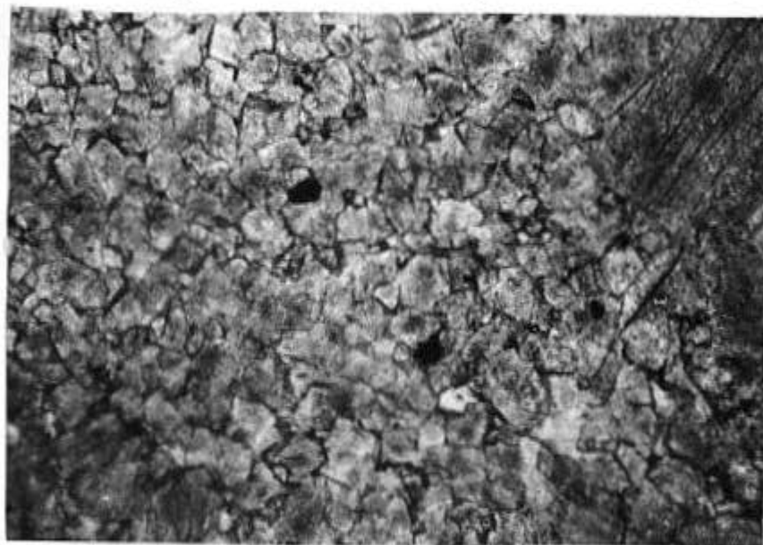
Рис 3.1.2. Вторичный кавернозно-пористый доломит, развитый по коралловому известняку. Мелко-зернистый доломит развит по матриксу, крупно-кристаллический доломит (в правом верхнем углу) замещает фрагменты кораллов. Афонинский горизонт, Ливкинская площадь. Обр. 37/1, скважина 37, глубина 4900-4911. Шлиф без анализатора, ув. 90.
